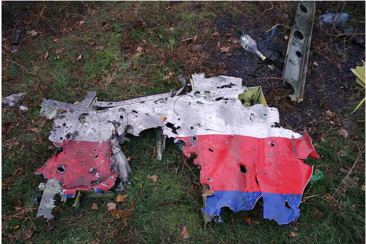
Ein von kleinen Schrapnells zerschlagenes Stück des MH17-Fliegers.
