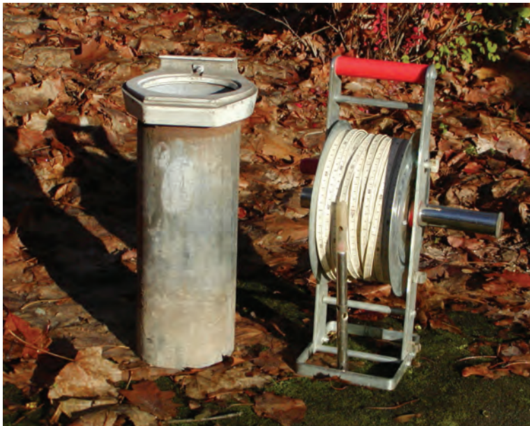
Abb. 3.2.3-1 Lichtlot zur Messung des Grundwasser- stands in einer Grund- wassermessstelle (Foto: StUA Lippstadt)
