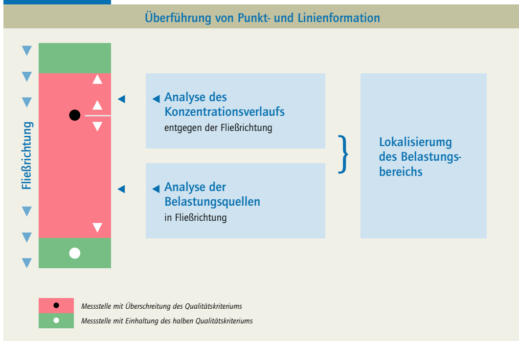
▶ Abb. 2.1.3.1-2 Schematische Darstellung der Quellen- und Auswirkungsanalyse für die Banddarstellung
