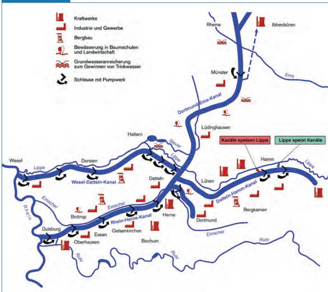
► Abb. 3.1.4-1 System der westdeutschen Schifffahrtskanäle (Quelle: Wasserverband Westdeutsche Kanäle)
