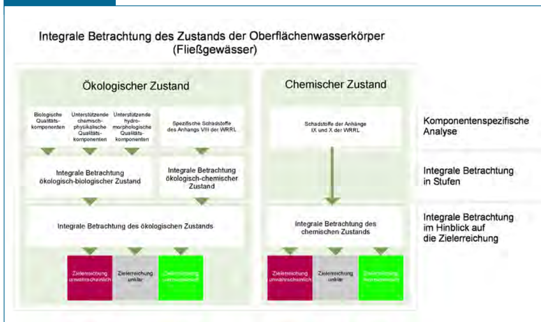
▶ Abb. 4.1.1-1 Systemvorgaben der WRRL zur integralen Bewertung des Zustands der Oberflächenwasserkörper
