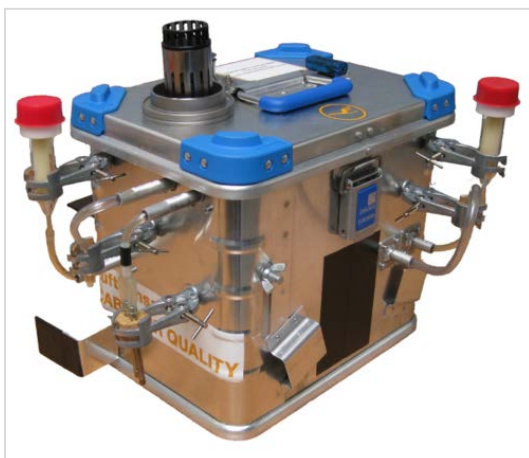
Abbildung 2: Dieser Messkoffer wird an Bord in der Kabine und im Cockpit eingesetzt
